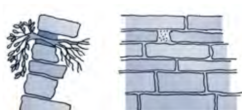
Figuur III.59: Bij het opbouwen van een keermuur kunnen holtes vrijgehouden worden voor de aanplant van planten. Ze wortelen dan in het achterliggende substraat en zijn veel minder blootgesteld aan extreme standplaatsseigenschappen. Op muren op het zuiden, krijgen de planten het op dergelijke groeiplaatsen veel warmer dan in volle grond (figuur uit Hansen & Stahl 1993).
